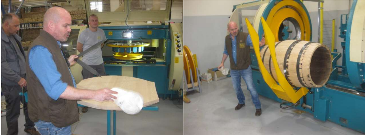
Links: Der Zirkel in der linken Hand von Herrn Gantenbrink bestimmt die vom „weißen Licht“ in der Maschine aufgenommene Kreisbewegung und gibt die Daten an die Fräse Rechts: Einlegen des Fasses in die Bürst- und Deckelringfräsmaschine
