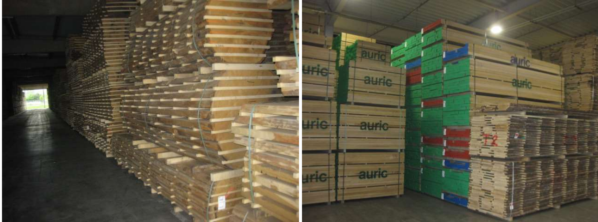
Bild 3: Schnittholzsortimente aus slawonischer Eiche (Fotos: M. Paulitsch)
