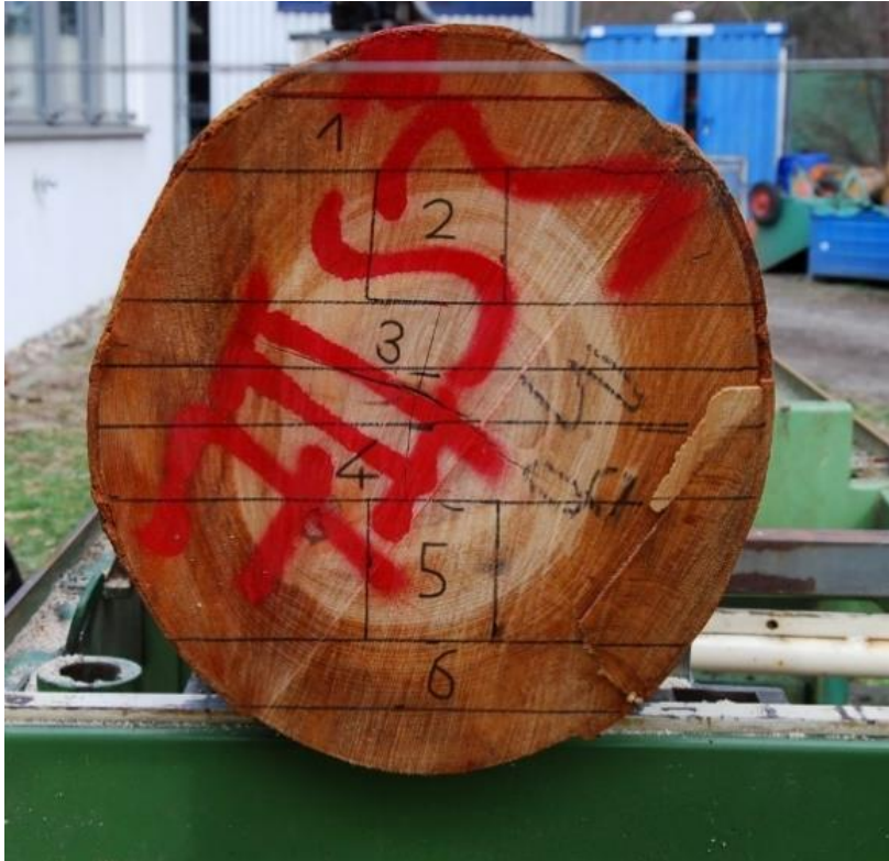
Sägeabschnitt auf der Blockbandsäge
