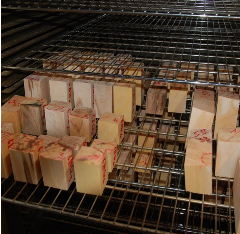
Proben zur Bestimmung des Feuchtgehaltes im Trockenschrank
