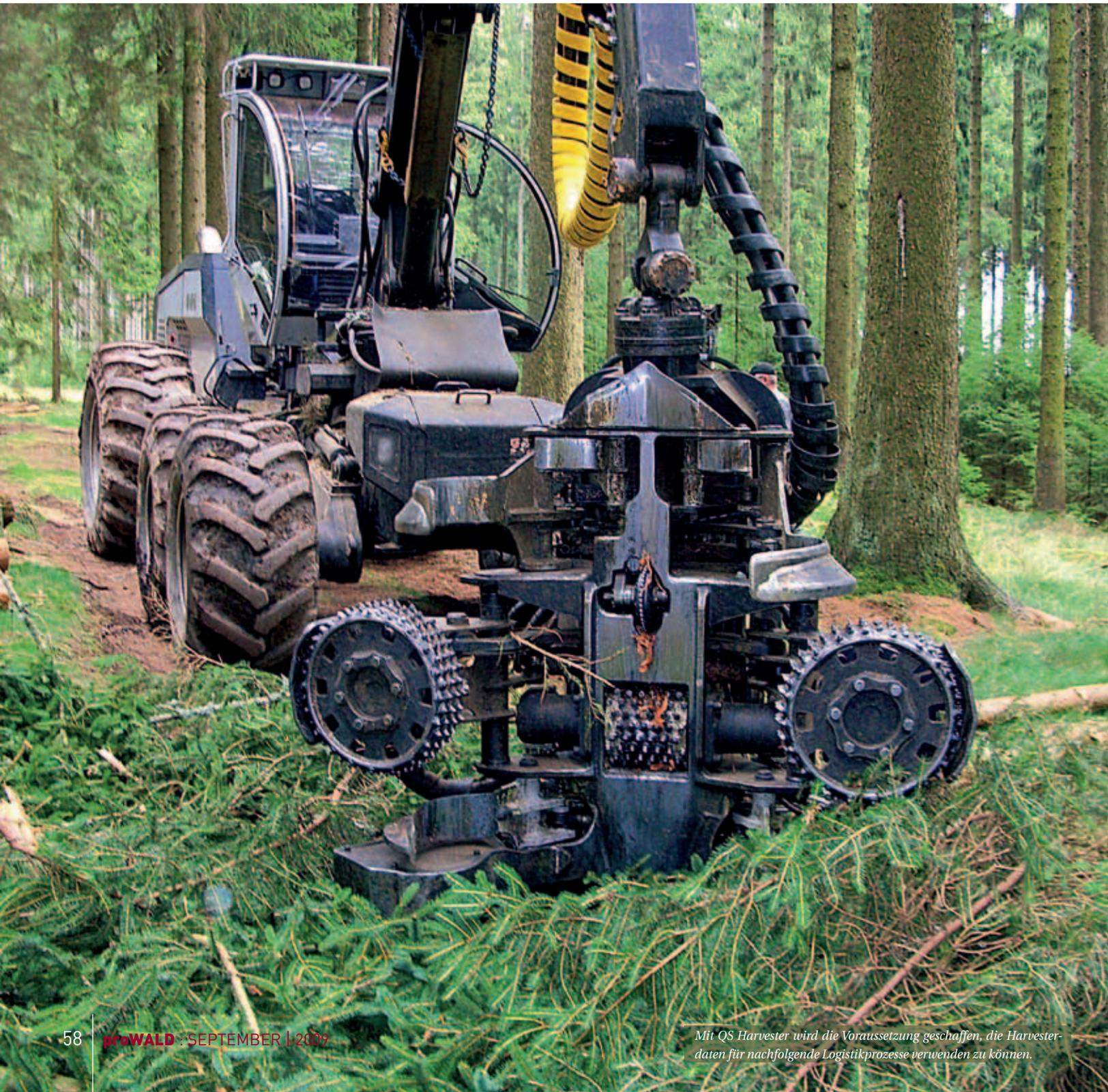
Bei der voll mechanisierten Holzern- te erfassen die Bordcomputersysteme der Harvester die Grunddaten Länge und Durchmesser der aufgearbeiteten Sortenstücke und stellen diese Informationen für eine Vielzahl von Auswertungen zur Verfügung. Für die forstliche Informationslogistik sind damit die Daten der Harvestervermessung von zentraler Bedeutung.
